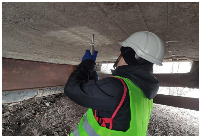
Рисунок 19 — Процес визначення міцності бетону для монолітного бетону плити проїзної частини по середині довжини консолі К(2-3)
