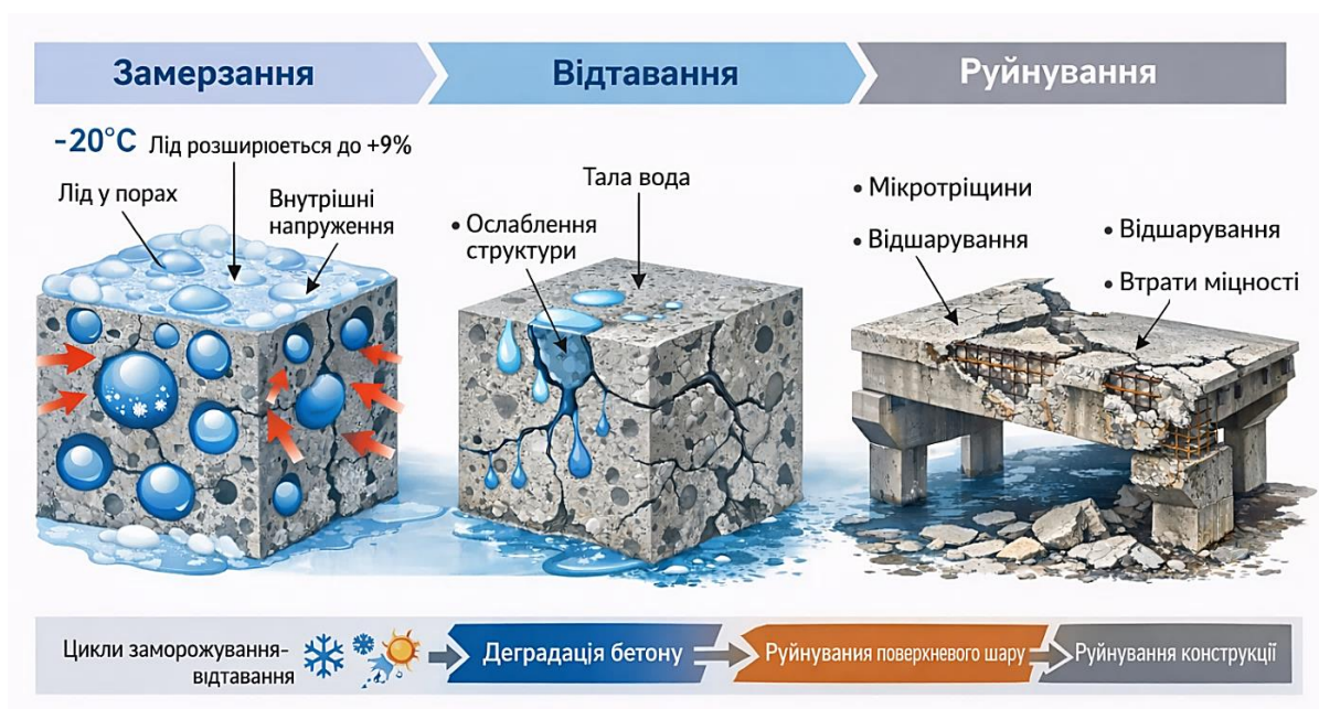
Рисунок 1 — Механізм морозного руйнування бетону
