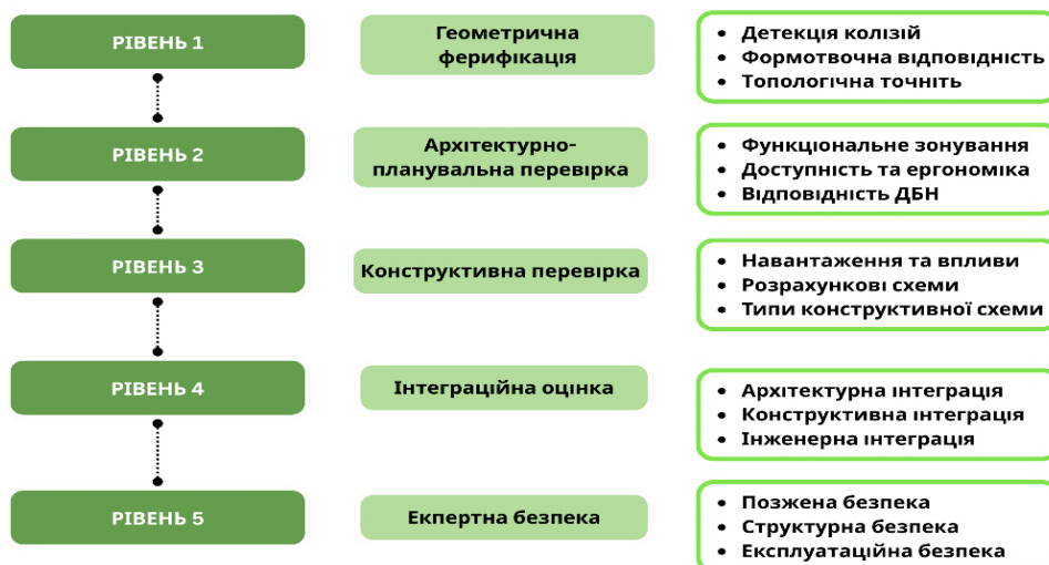
Рисунок 1 — Структурна модель п'ятирівневої системи контролю якості BIM
